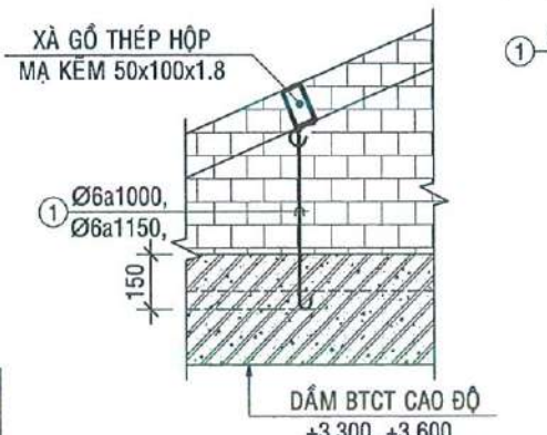
BẢNG THỐNG KÊ CỐT THÉP CHI TIẾT 4: NEO XÀ GỖ MÁI
