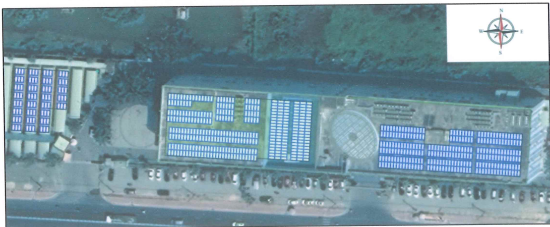
Hình 4-2: Mặt bằng bố trí tấm pin năng lượng mặt trời tại TTTM Satra Củ Chi
