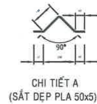
CHI TIẾT BỘ ĐÀ LỆCH TOÀN PHẦN DÀI 1,5M
