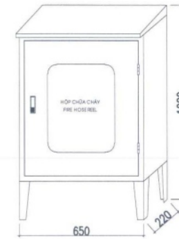
HỘP HỢNG NƯỚC CHỮA CHÁY NGOÀI NHÀ
