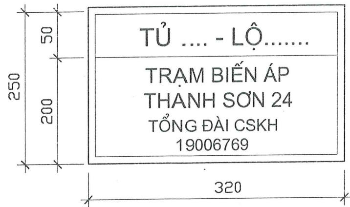
BIỂN TÊN TỦ - TỶ LỆ 1/5 (CHẾ TẠO 01 CÁI - GẮN TẠI TỦ ĐIỆN CÔNG TƠ)
