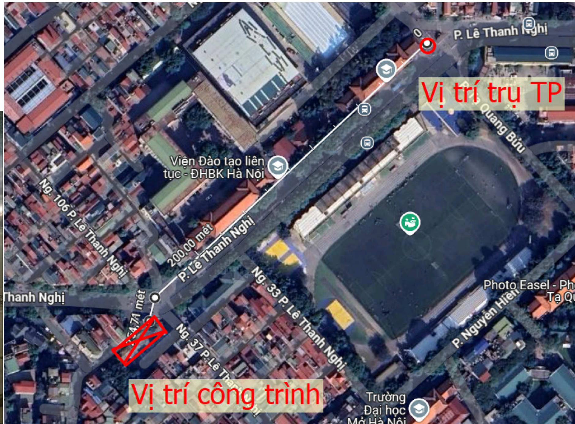
KHOẢNG CÁCH GIỮA TRỤ CHỮA CHÁY THÀNH PHỐ VÀO CÔNG TRÌNH
