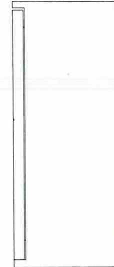
KẾT CẤU VỎ TỦ BẰNG NHỰA COMPOSIT HOẶC THÉP CT3
