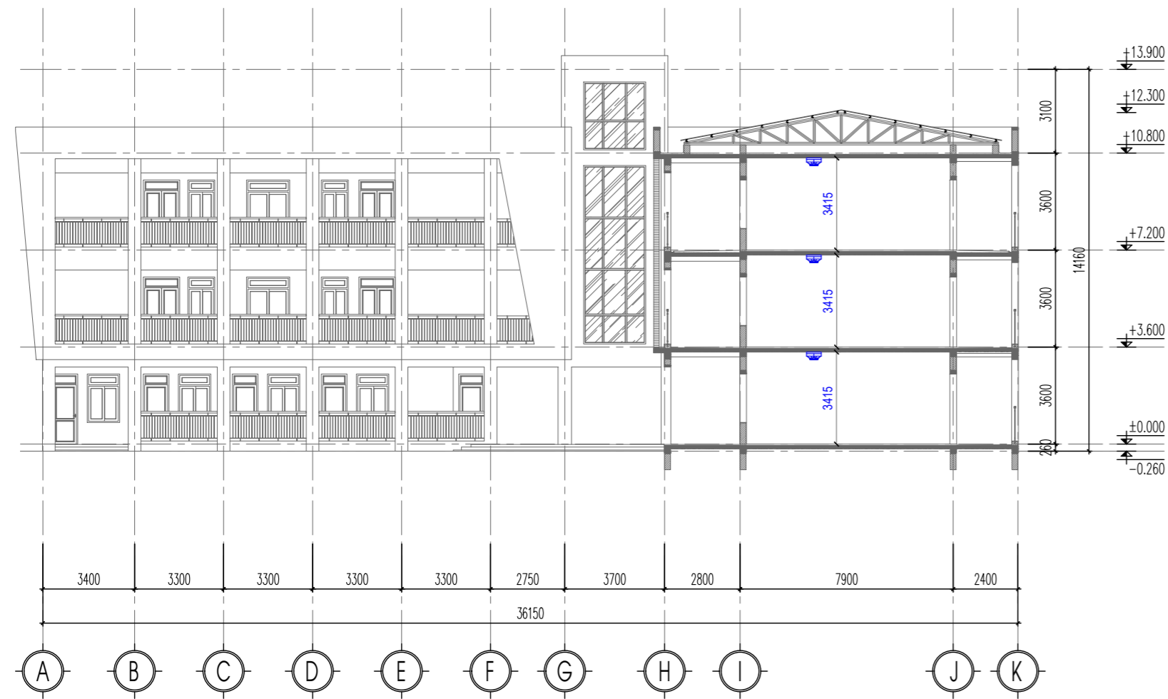
MẶT CẮT LẮP ĐẶT BẢO CHÁY (CÁT 2-2)
