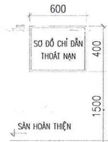
LẮP ĐẶT SƠ ĐỒ CHỈ DẪN THOÁT NẠN
