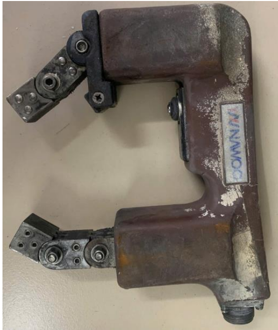
Thiết bị từ hóa (gông từ) để kiểm tra từ tính bề mặt gói trục
