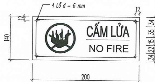
BIỂN CẤM LỬA - TỶ LỆ 1/5 (CHẾ TẠO 01 CÁI - GẮN TẠI TỦ ĐIỆN CÔNG TƠ)
