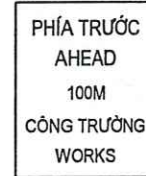
1 2 3 BIỂN BÁO 441A, B, C : PHÍA TRƯỚC LÀ CÔNG TRƯỜNG
