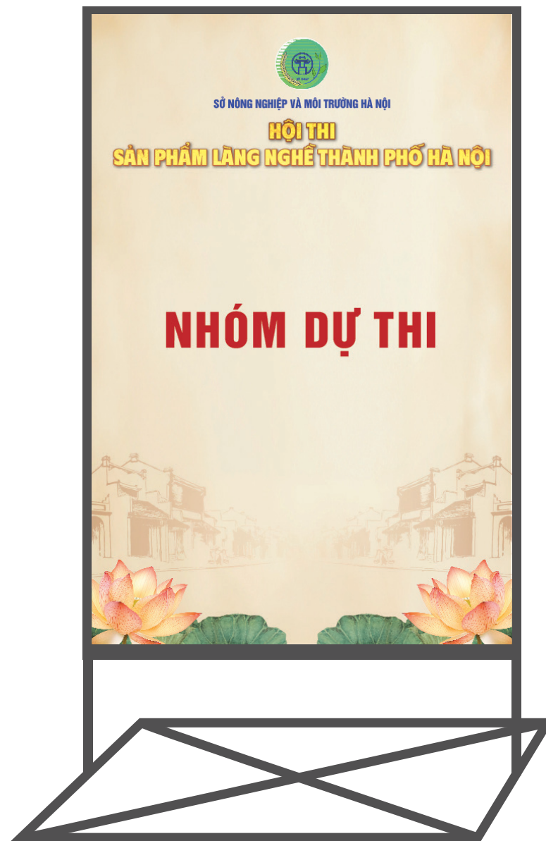
Pano nhóm dự thi Chân đứng cao 1.5m rộng 1m, khung hàn sắt hộp kẽm vuông để làm chữ X 2 mặt in decal PP cán bóng Số lượng: 5 bộ
