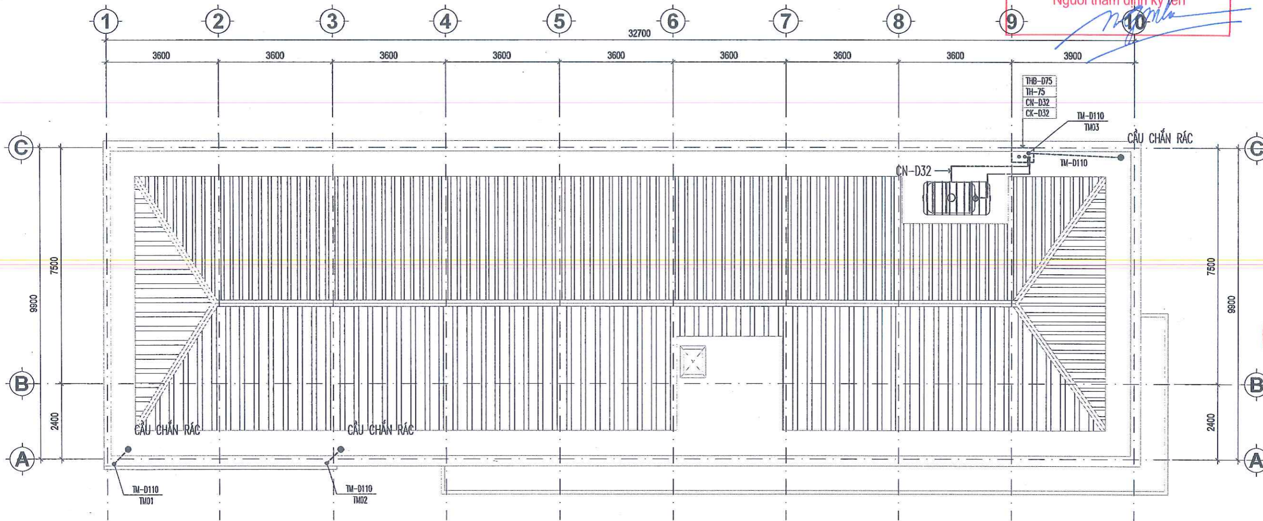
MẶT BẰNG CẤP THOÁT NƯỚC MÁI
