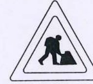
6 BIỂN BÁO W227: CÔNG TRƯỜNG
