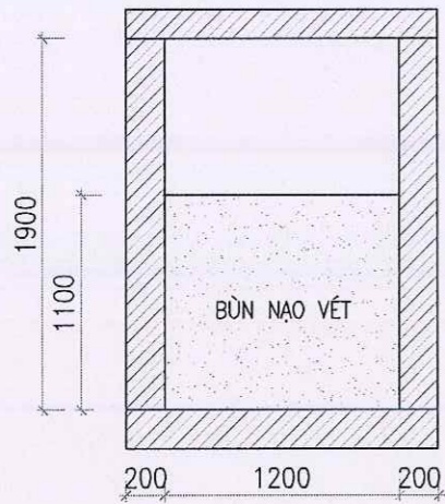
MẶT CẮT Bùn TRONG CỐNG HỘP (TẠI SỐ 486)
