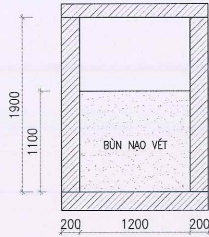
MẶT CẮT Bùn TRONG CỐNG HỘP (TẠI SỐ 524)
