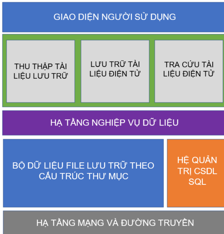
Hình: Mô hình kiến trúc chi tiết phần mềm khai thác tài liệu số hóa
