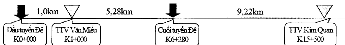
Hình I.4: Sơ đồ các trạm thủy văn và tuyến đê tả Tích phạm vi nghiên cứu
