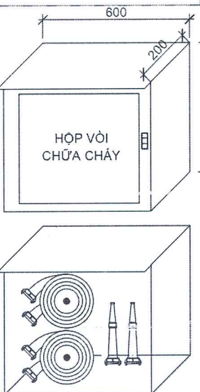
HỘP ĐỰNG VỎI CHỮA CHÁY NGOÀI NHÀ Ø65, LĂNG PHUN Ø65
