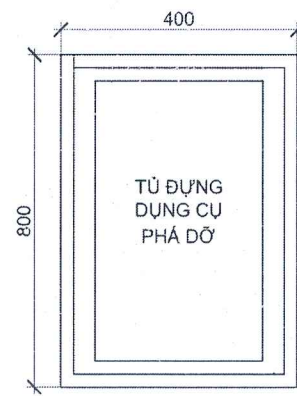
TỦ ĐỰNG DỤNG CỤ CHỮA CHÁY
