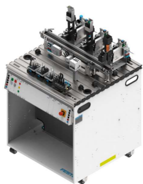
Trạm Cấp phôi
