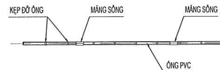
CHI TIẾT LẮP ĐẶT ỚNG LUỒN DÂY PVC
