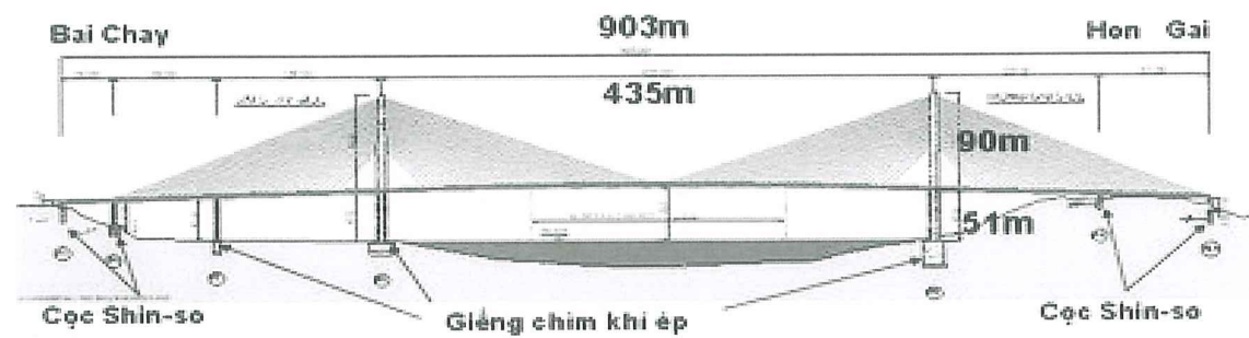
Hình 1: Bố trí chung cầu Bãi Cháy
