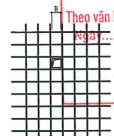
(c) NẾU BỀ RỘNG LỖ MỎ B < 100mm, CHO PHÉP ĐẶT THÉP SÀN NHƯ HÌNH TRÊN
