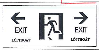
DANG ĐIỂN HXNH ĐÈN DẪN LỐI THOÁT NẠN DANG ĐIỂN HXNH LẮP ĐÈN, BIỂU CHỈ DẪN CỬA RA VỀ HAI PHÍA
