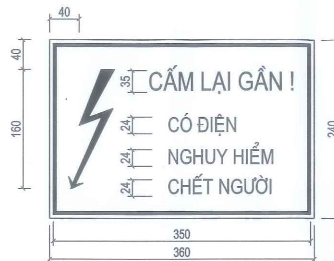
BIỂN BÁO AN TOÀN LẮP TẠI TRẠM BIẾN ÁP KIOS & TRẠM BỆT (Theo hình 3 QTAT điện năm 2014)
