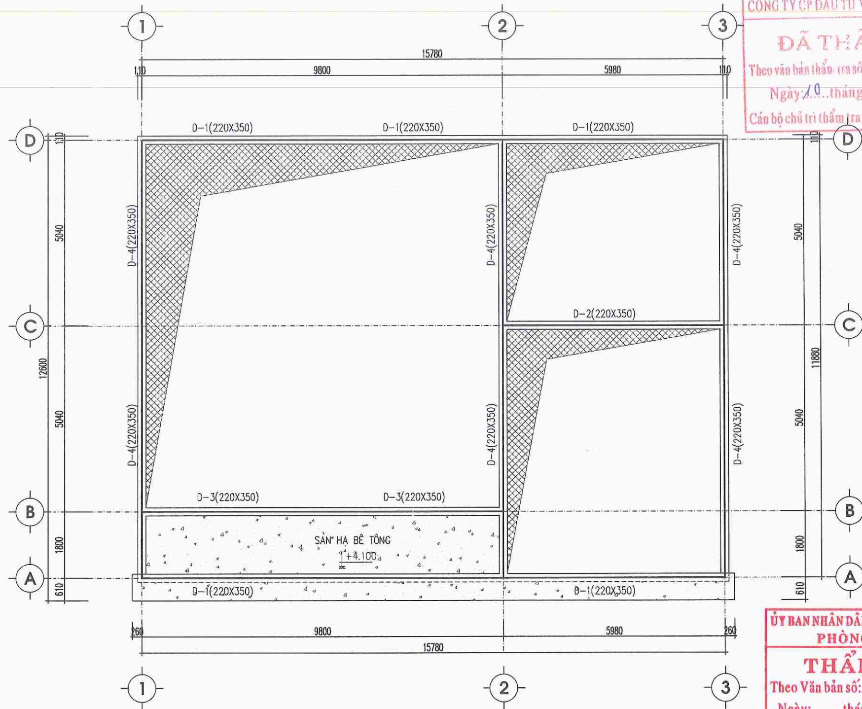
MẶT BẰNG KẾT CẤU MÁI
