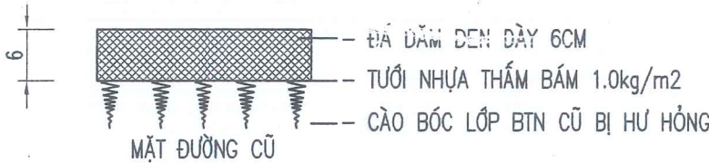
KC SỬA CHỮA HƯ HỎNG MẶT ĐƯỜNG CŨ (SC1)
