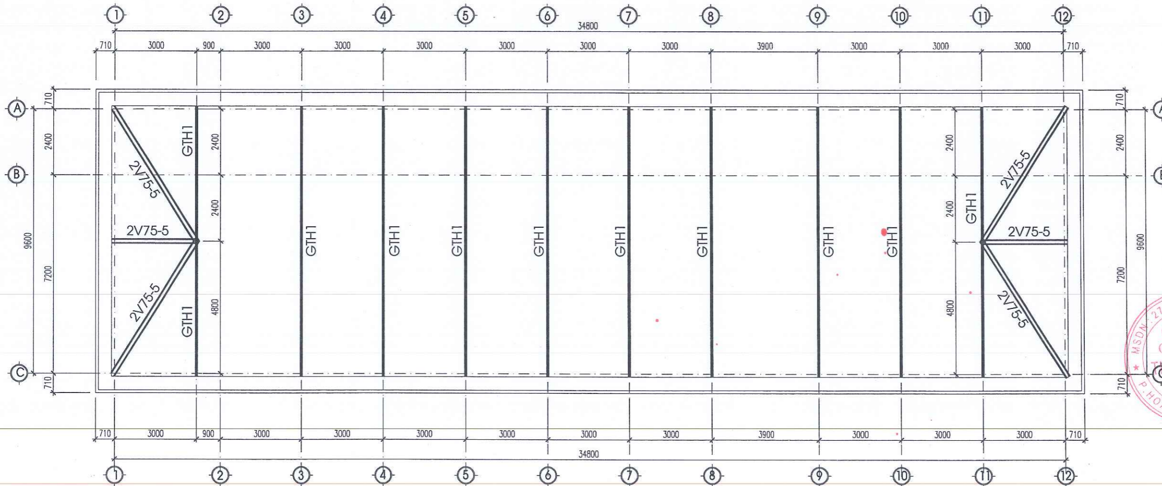
MẶT BẰNG BỐ TRÍ GIẰNG TƯỜNG THU HỒI MÁI
