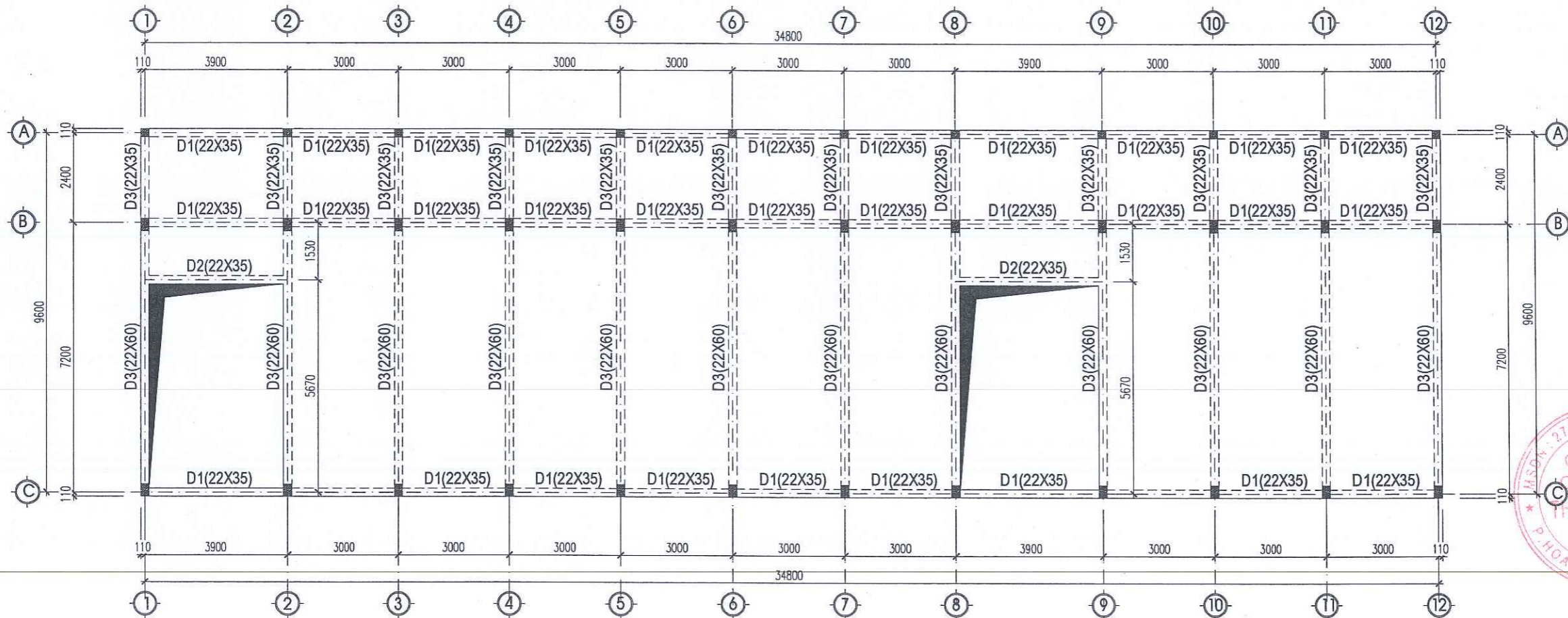
MẶT BẰNG KẾT CẤU DẦM, SÀN TẦNG 3
