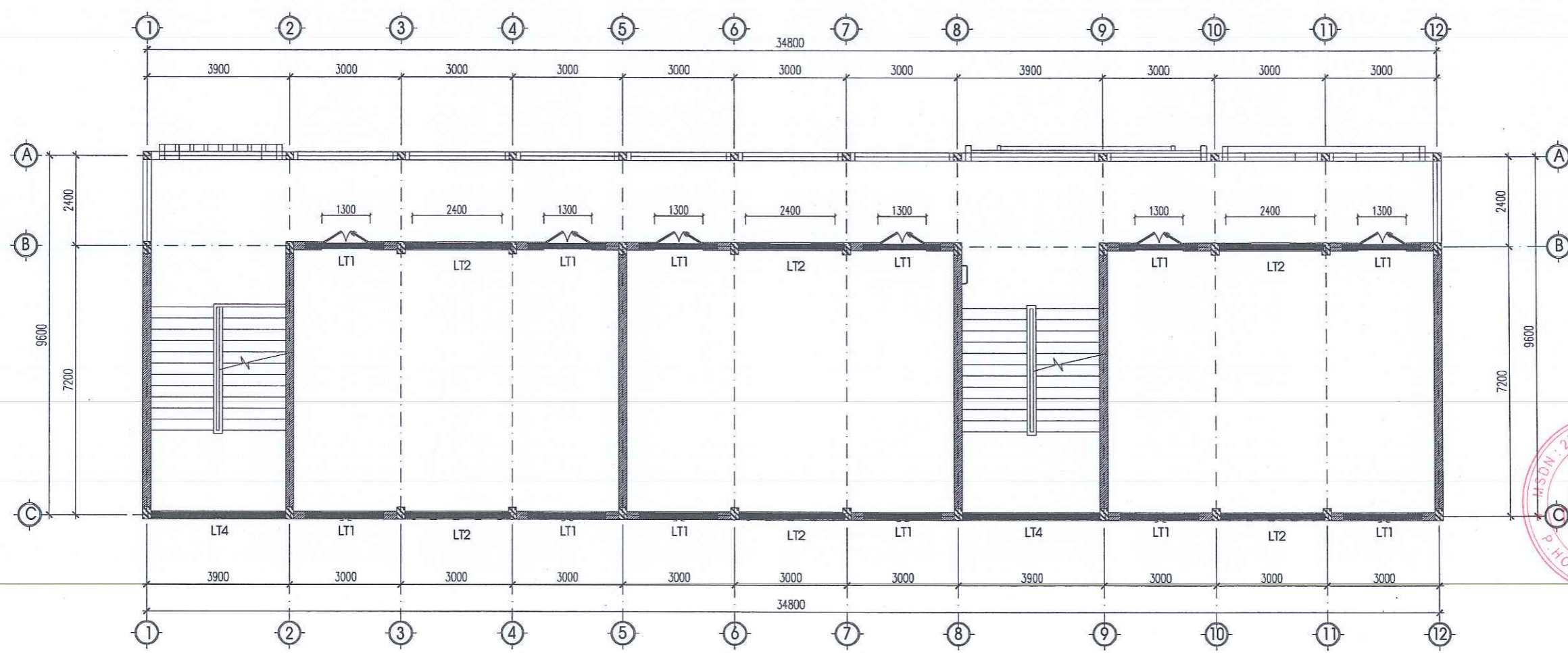
MẶT BẰNG BỐ TRÍ LANH TÔ CỬA TẦNG 3
