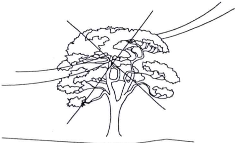
Không luồn dây cáp điện vào cành cây không thả dây điện dưới đất
