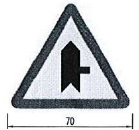
BIỂN BÁO W.207B: GIAO NHAU VỚI ĐƯỜNG KHÔNG ƯU TIÊN (ĐẶT Ở NGÃ BA)
