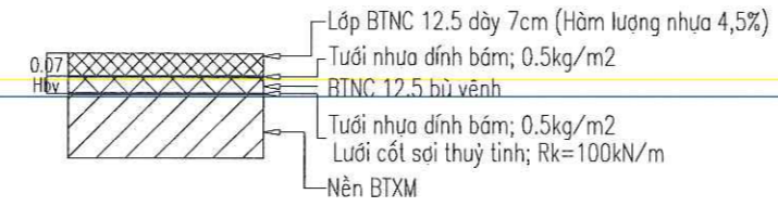
KC1 : KẾT CẤU BÙ VỆNH BẰNG BTN
