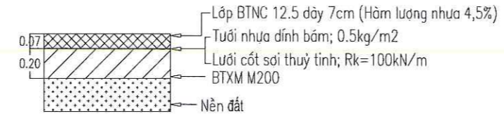
KC3 : KẾT CẤU VUỐT RẼ ÁP DỤNG CHO PHẠM VI ĐƯỜNG ĐẤT
