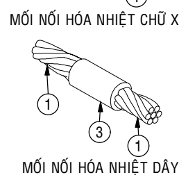
CHI TIẾT 1 MỐI NỐI LOẠI HÓA NHIỆT
