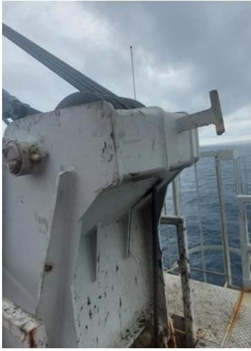
Cụm puly cáp giăng cân đỉnh tháp chữ A quay tốt, không bị kẹt ( Puly NYCAST)
