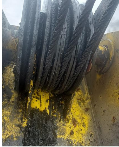
Cụm puly cáp giăng cân đỉnh tháp chữ A quay tốt, không bị kẹt ( Puly NYCAST)
