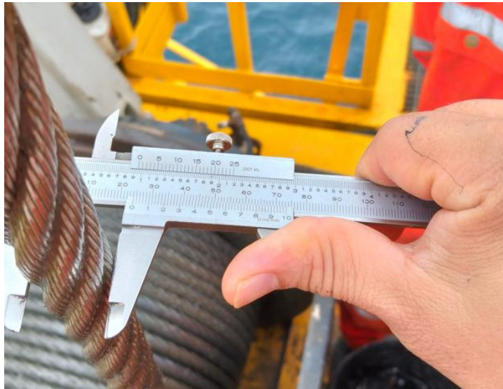
Đường kính cáp nhỏ nhất đo được là 24.3 mm
